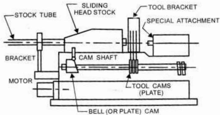
Fig. 2.3.2 LAYOUT OF SWISS TYPE AUTOMATIC SCREW MACHINE
